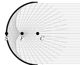
Rayons d'un faisceau collimaté réfléchis par un demi-cercle de centre  $C$  et de rayon  $R$ .
